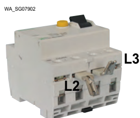
Одинаковый соединительный угольник ZV-L2/L3 (-80A) для L2 и L3, развернутый на 180°
